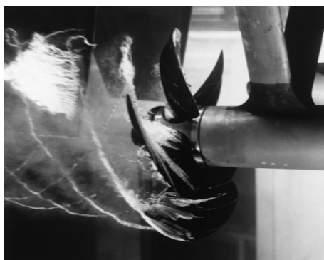
Cavitation créée expérimentalement par une hélice dans un tunnel d'eau
