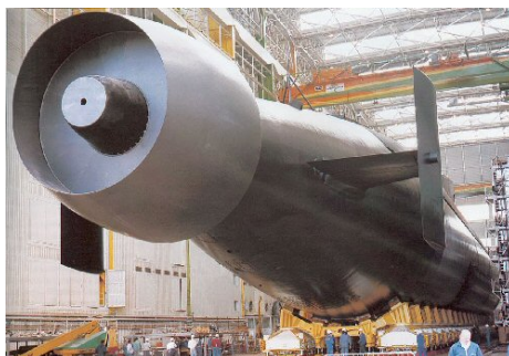
Hélice carénée de sous-marin de type Scorpène (non dévoilée entièrement pour cause de secret défense)
